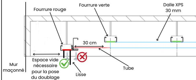
Pose du plafond et plaque de plâtre avant pose du doublage
