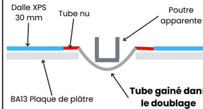
Passage de gaine contenant le tube sous poutre, avec plaque de plâtre et fourrure rouge sous poutre
