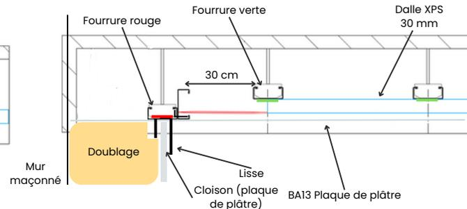
Pose du plafond et plaque de plâtre après pose du doublage
