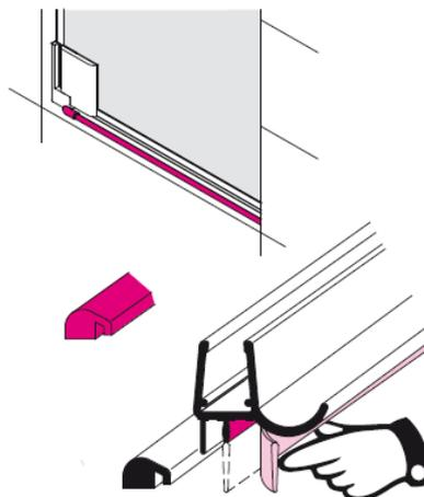
Joint horizontal bas type gouttière adaptable lors de la pose avec ou sans seuil d'étanchéité
