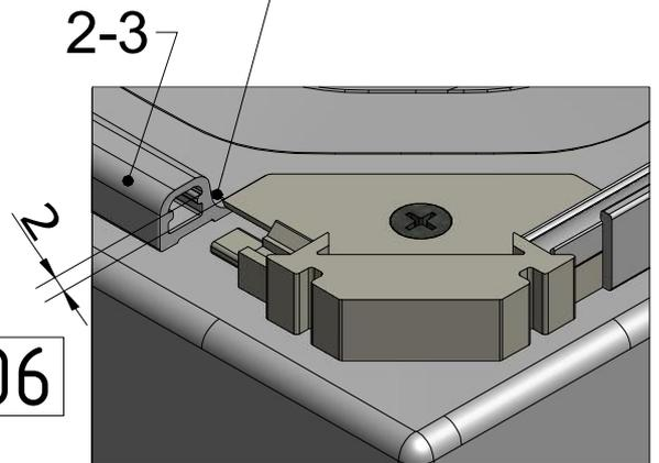
Version avec la porte côté droit (Utiliser la pièce part 2-6 pour le côté gauche)
