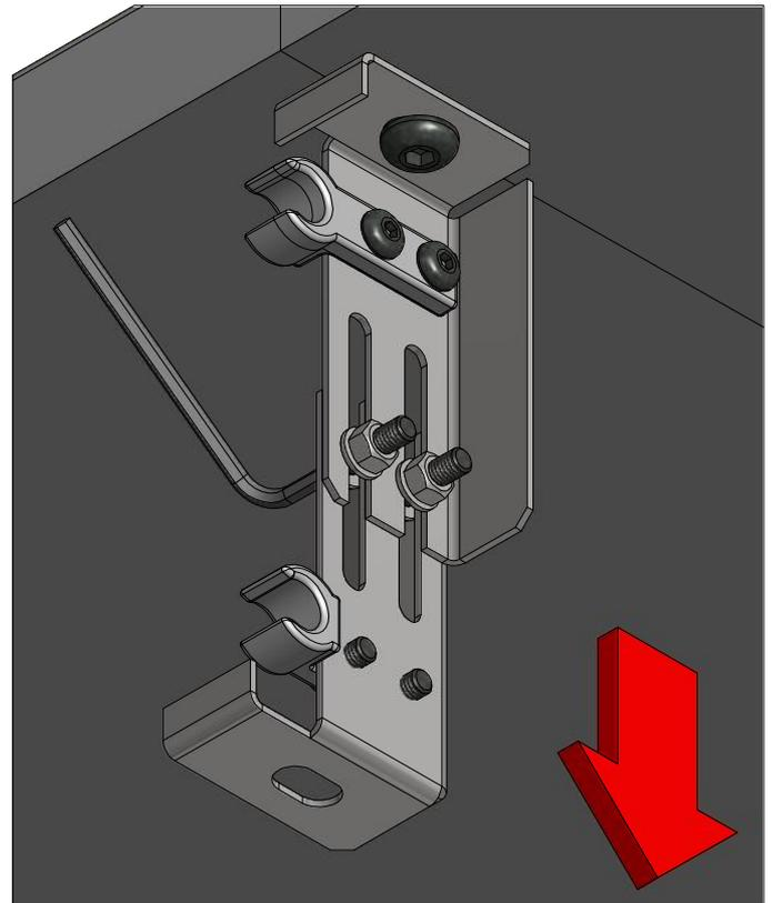
Régler la hauteur des supports du tablier
