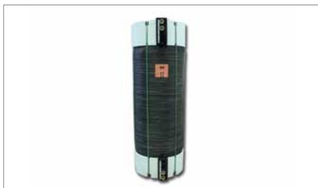
12) Lorsque le ballon de stockage a été positionné sur le lieu d'installation, l'isolation peut être remontée. Procéder à cet effet dans l'ordre inverse du démontage, c'est-à-dire en commençant par le bas. Les éléments d'isolation sont numérotés pour assurer leur bon ordre de montage. Les éléments 1 et 2 sont montés en bas, 3 et 4 au centre et 5 et 6 en haut.
