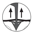
Le harpon inférieur est très stable et possède une pointe tranchante, tandis que l'ardillon au-dessus est particulièrement élastique. Cette technologie spéciale assure une pénétration facile et sûre à travers le film isolant de l'isolation et optimise ainsi la facilité d'installation et augmente la vitesse de réalisation. La stabilité du harpon inférieur offre une fonction de support idéale pour le harpon supérieur.
