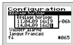
Exemple : modification de 14:19 en 14:23. L'unité possède une horloge à quartz. Elle doit être vérifiée lors des visites de maintenance
