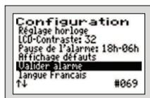
En cas de dysfonctionnement (déclenchement de l'alarme), celui-ci peut être réinitialisé en PAS DE DÉFAUT en appuyant sur la touche
