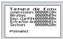
Le menu TEMPS DE FONCTIONNEMENT permet d'afficher le temps de fonctionnement des différents équipements électriques. Le temps de fonctionnement augmente dès que l'unité de commande met le compresseur ou la pompe en marche. L'affichage s'effectue en heures et en minutes.
