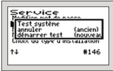
Le mode test est sélectionné via l'option de menu DÉMARRER TEST. Le mode test sert à déterminer si la consommation des équipements électriques est conforme.
