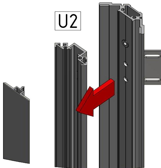
Avant installation retirer le cache et le profilé de blocage - dévisser 2x 3e-3
