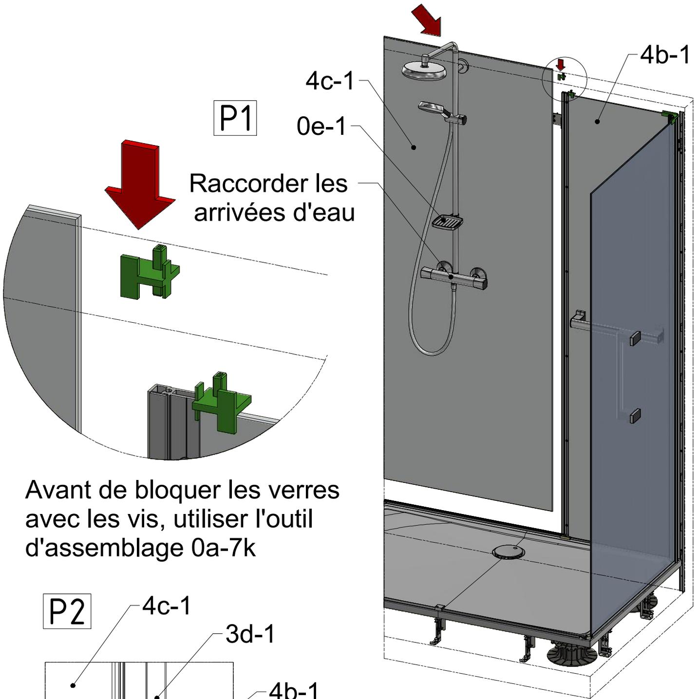
Avant de bloquer les verres avec les vis, utiliser l'outil d'assemblage 0a-7k
