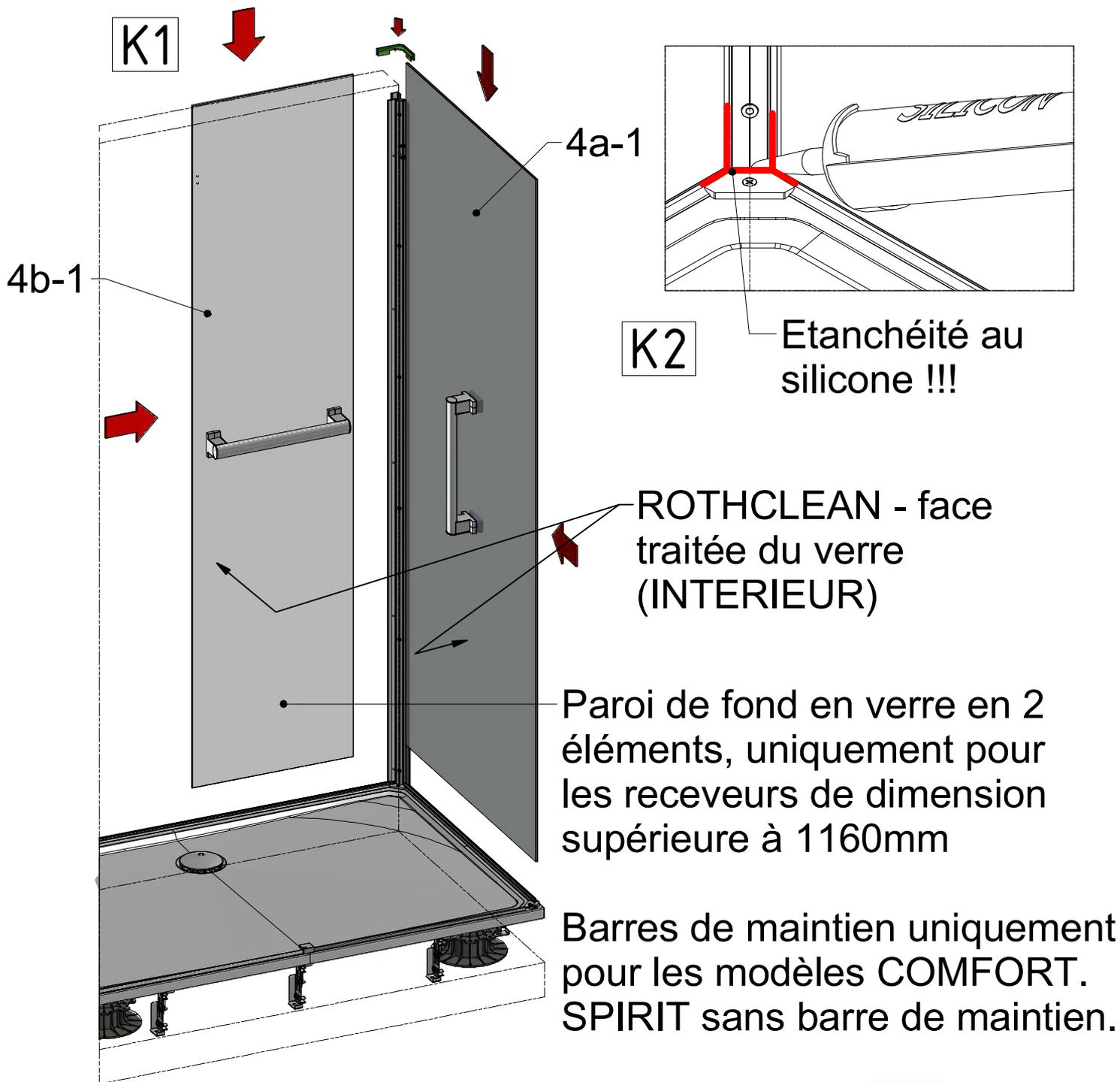
Avant de bloquer les verres avec les vis, utiliser l'outil d'assemblage 0a-7
