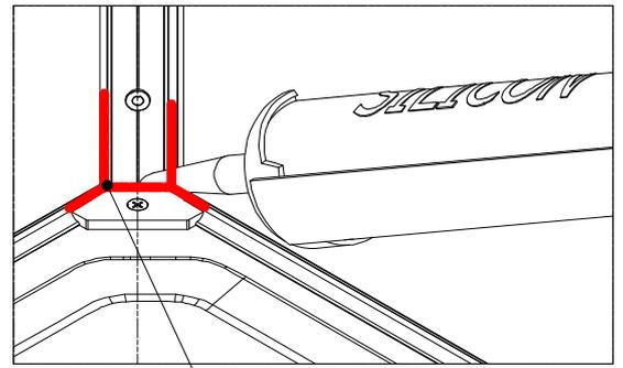
T2 Etanchéité au silicone !!!
