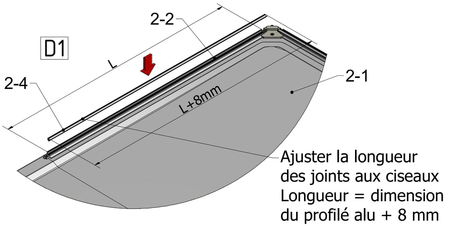
D2 et D3 : uniquement pour installation sans baguette d'étanchéité
